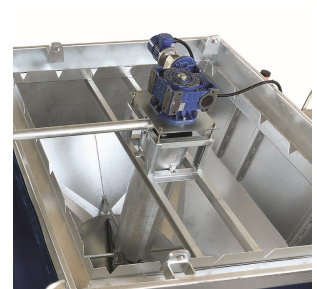
Detailansicht des Dekanter-Rührwerks. Untersetzungsgetriebe für langsame Rotation
