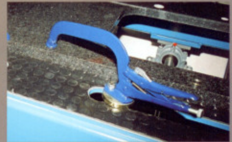
Spannzangen zur Werkstückfixierung Clamps to hold working pieces
