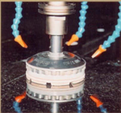
Schleifen und polieren von Oberflächen Grinding and polishing of stone surfaces
